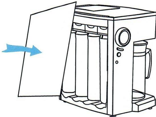
**Hinweis! Sollten Sie nach dem Entkalkungsprozess neue Filter und/oder Membrane(n) einsetzen dann müssen diese zunächst gespült werden. Führen Sie dafür die Schritte aus der Anleitung für den Filterwechsel durch.**
